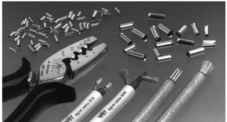
Für die Crimp-technik bietet WBT eine breite Palette an Accessoires: vergoldete Aderendhülsen aus hochleitfähigem Elektrolytkupfer (E-Cu mit Reinheit > 99,996%) in allen Normgrößen von 0,5 bis 16 mm<sup>2</sup>, eine spezielle Crimpzange für die o.g. Anforderungen und ein komplettes Crimpset für Einsteiger.
